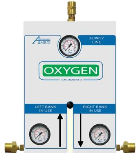
Los manifolds automáticos están diseñados para el suministro constante e ininterrumpido de gas (oxígeno, óxido nitroso, etc.), al hospital a través de la sustitución del sistema de suministro al de reserva en forma automática. Las conexiones y tuberías se han diseñado para entrega máxima del flujo, con una caída mínima de presión en el sistema.
